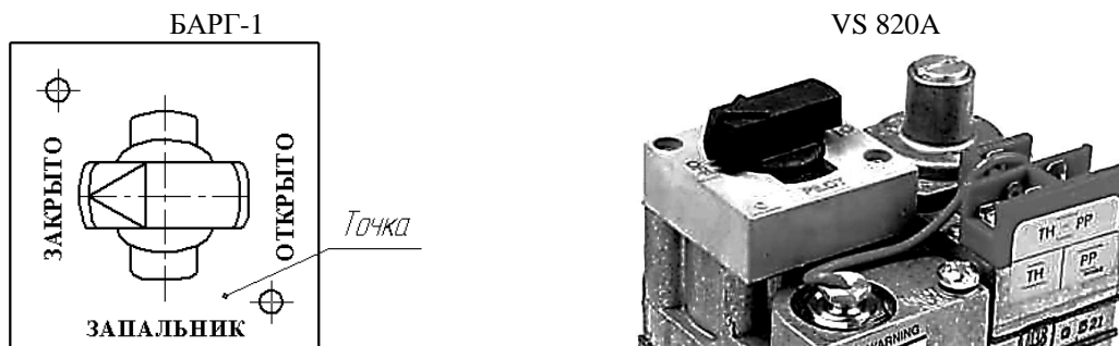
Рисунок 17 – Ручка блока регулятора газовой горелки.
